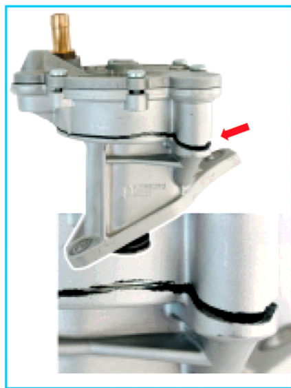
Sl. 1 Polomljeno kućište pumpe
