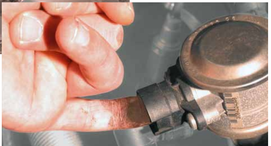
Verificação rápida da válvula de ar secundário no BMW 520i (destacada)
