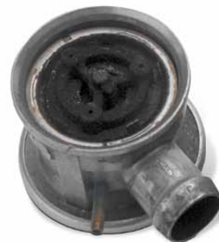
Avarii cauzate de condensul de eșapament
