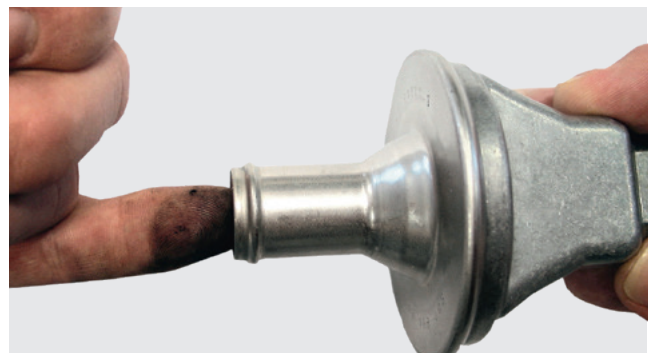
Obr. 1: Jednoduchá kontrola zpětného ventilu
