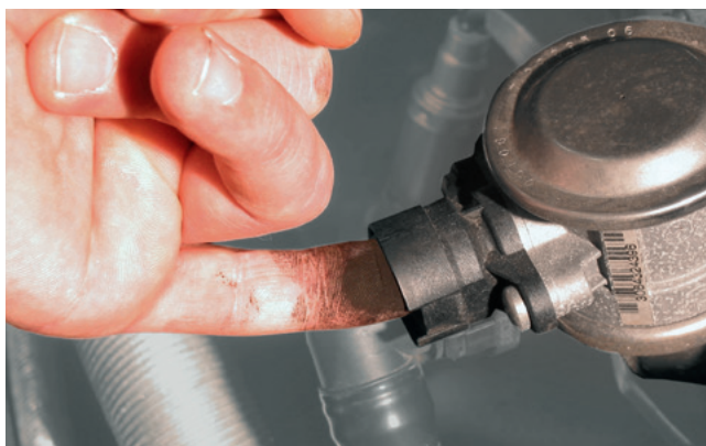
Rychlá zkouška u ventilu sekundárního vzduchu v BMW 520i (zvýrazněna)
