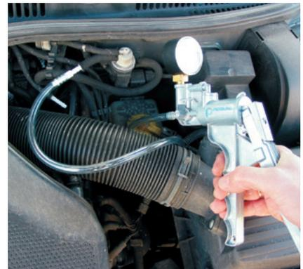
Ob pneumatische AGR-Ventile oder wie hier ein Druckwandler: Mit einer Handunterdruckpumpe lässt sich die Funktion leicht prüfen.
