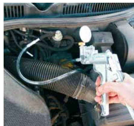
Pneumatikus EGR szelepek vagy mint jelen esetben, EPW szelepek működése kézi vákuumszivattyú segítségével könnyen ellenőrizhető.
