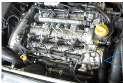
举例: 欧宝威达 (Opel Vectra) 通过凸缘内的孔来实现润滑油供给。
