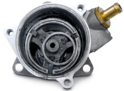
脏污、严重老化的机油引起的润滑不足。
