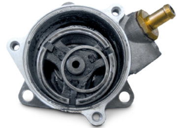
Manque d'huile lubrifiante suite à une huile moteur contaminée, trop vieille.
