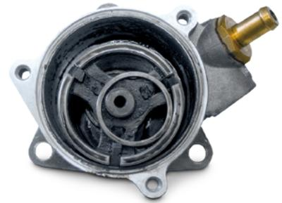
Lubrificazione insufficiente a causa di olio motore sporco e vecchio.
