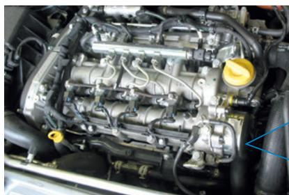
Exemplo: no Opel Vectra, a alimentação de óleo lubrificante processa-se mediante furos no flange.
