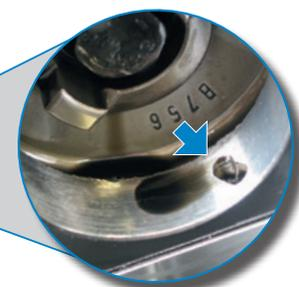
Atender à limpeza impreterivelmente! Os restos de óleo carbonizado e as juntas unitárias podem levar ao fechamento dos furos do óleo lubrificante.
