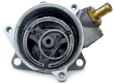
Falta de óleo lubrificante devido ao óleo do motor contaminado e vencido.
