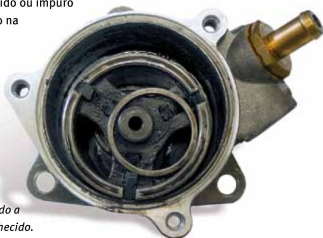
*Falta de óleo lubrificante devido a óleo do motor impuro e envelhecido.*
