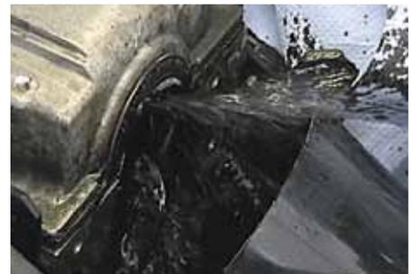
*Atenção: Com uma boa alimentação de óleo lubrificante, podem aqui fluir 30-60 litros por hora.*
