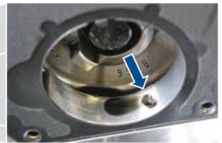
*Exemplo: No caso do Opel Vectra, a alimentação de óleo lubrificante realiza-se por meio de furos no Flange*
