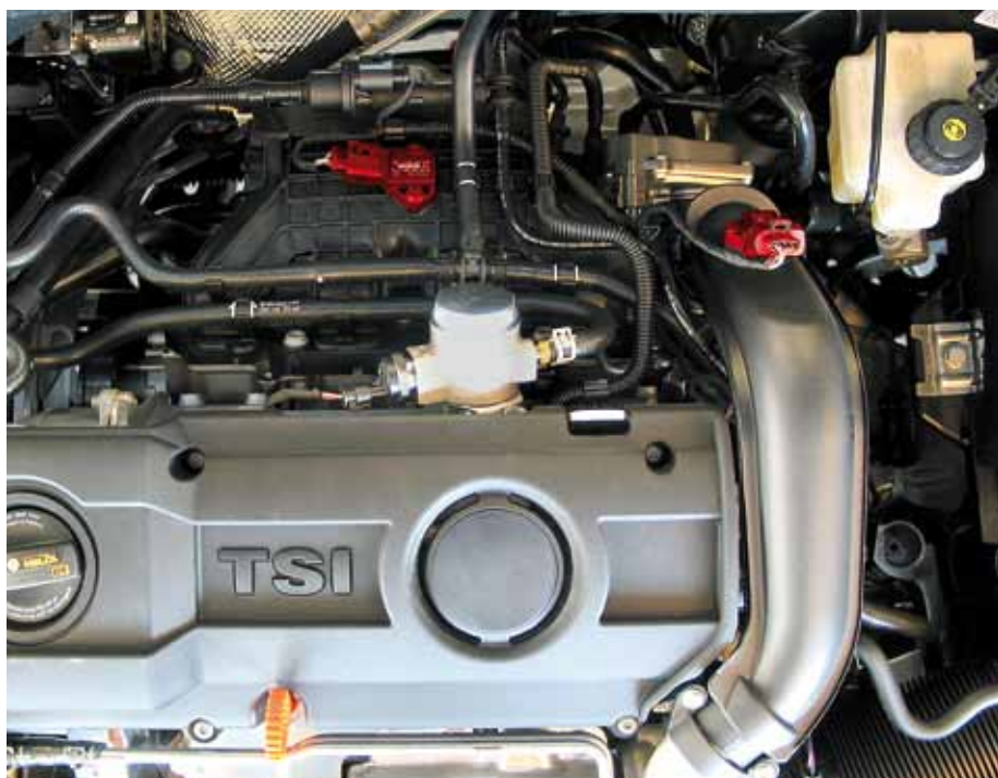
Snímač tlaku v sacím potrubí (vlevo) a snímač plnicího tlaku (vpravo) u VW Golf VI (červeně zvýrazněno)
