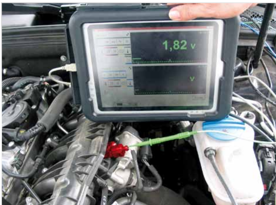
Měření výstupního napětí na snímači tlaku v sacím potrubí (zvýrazněno) u vozu Audi A4 TFSI
