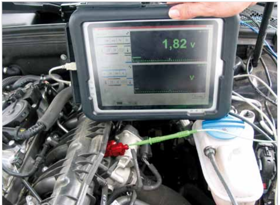
Metten van de uitgangsspanning op de zuigpijp-druksensor (geaccentueerd) in de Audi A4 TFSI
