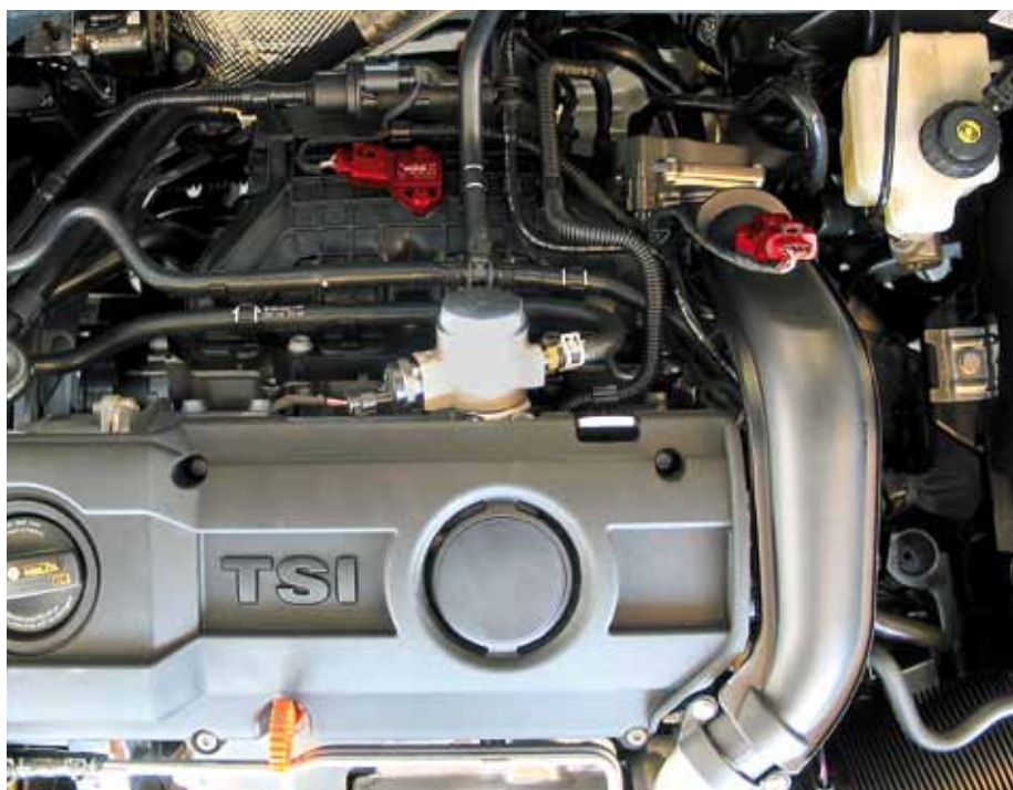
Zuigpijp-druksensor (links) en laaddruksensor (rechts) in de VW Golf VI (rood geaccentueerd)
