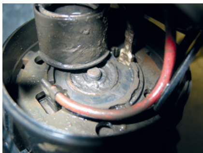
Condensação dos gases de escape agressiva no motor de acionamento de uma bomba de ar secundário
