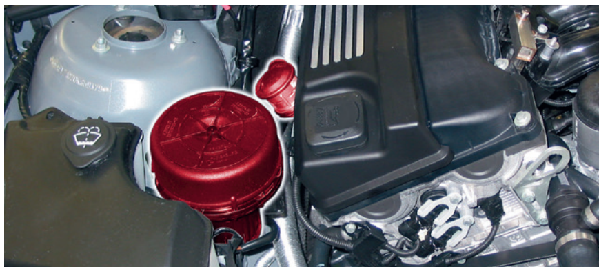
Válvula de ar secundário e bomba de ar secundário em um BMW E46 (em destaque)
