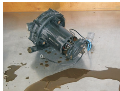
Condensação dos gases de escape líquida de uma bomba de ar secundário
