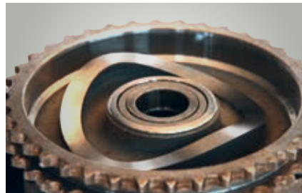
Came en bon état
