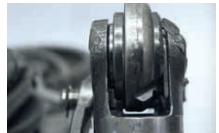
Kárhelyzet: egyoldalúan elkopott futógörgő
