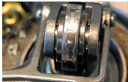
Obraz uszkodzenia: wałek bieżny z karbami (pitting) spowodowanymi przez zużyłą tarczę krzywkową
