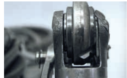
Obraz uszkodzenia: jednostronnie starty wałek
