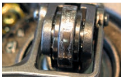
Картина повреждения: приводной ролик с насечками (питтинг) из-за изношенного эксцентрика
