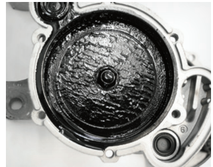
图 3: 大众面包车真空泵内的油泥导致啪嗒作响
