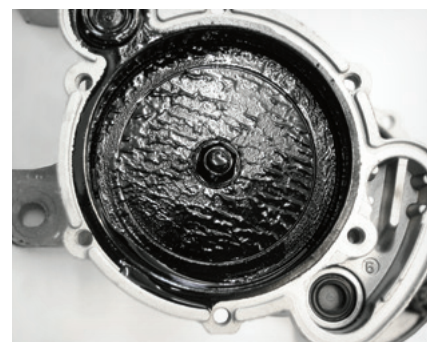
Fig. 3: El lodo de aceite en la bomba de vacío del VW Transporter produce ruidos de tableteo
