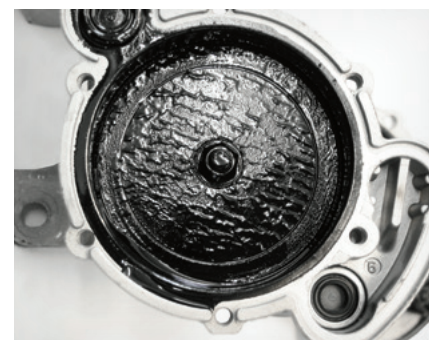
Fig. 3: Crusta de ulei din pompa de vid de la vehiculul comercial VW Transporter duce la apariția huruiturilor
