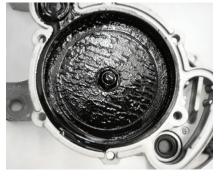
Şekil 3: VW Transporter vakum pompasındaki yağ tortusu takırdama seslerine neden oluyor
