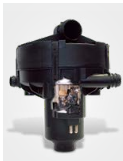
Vista da bomba de ar secundário (em corte) com vestígios de derretimento
