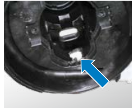
Hasar belirtisi: Gövdede erime izleri (gövdeye yukarıdan bakıldığında)
