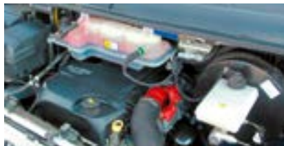
Clapeta de reglare (evidențiată în roșu) în camera motorului unui Iveco Daily 3.0 l
