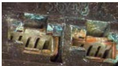
Empalme con humedad y restos de corrosión
