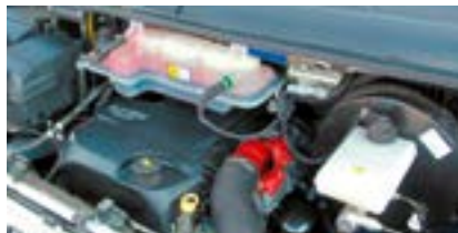
Válvula reguladora (destacada a vermelho) no compartimento do motor de um Iveco Daily 3.0 l
