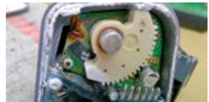
Vista para o interior de uma válvula reguladora danificada
