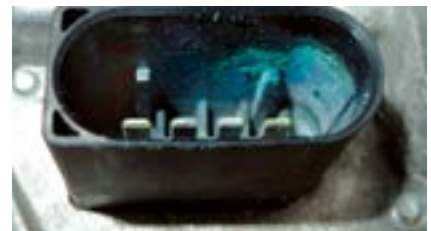
Разъём на корпусе заслонки со следами коррозии
