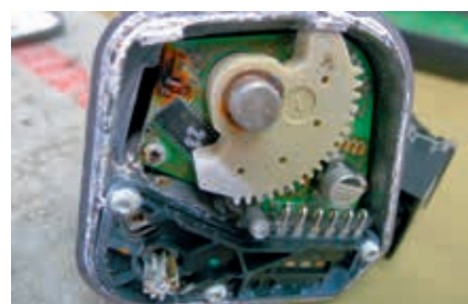
Pogled u unutrašnjost oštećene regulacione klapne
