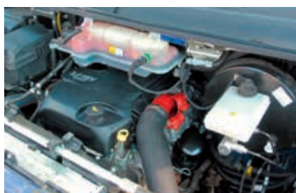
Regulaciona klapna (istaknuta crvenom bojom) u motornom prostoru Iveco Daily 3.0 l
