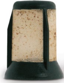
E3T'nin ön filtresi – pas nedeniyle tıkanmış
