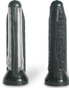
E1F'nin ön filtresi: sol yeni, sağ tıkanmış
