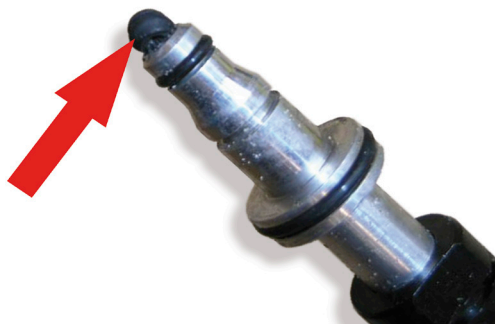
Obrázek 4: Pokud nebude starý těsnicí kroužek odstraněn, bude zatlačen do CSC a ucpe hydraulické vedení
