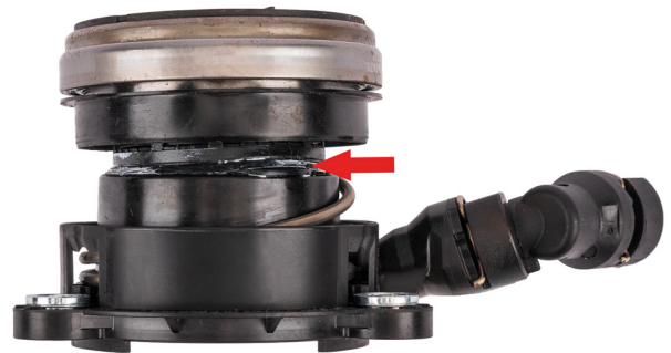
Image 4 : Butées hydrauliques détériorées suite à un montage incorrect
