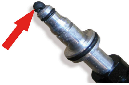
Slika 4: Ukoliko se ostaci brtvenog prstena ne uklone, utiskuju se unutar HPL-a i blokiraju slobodan protok radnog medija
