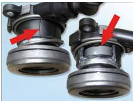
Slika 5: Centralni izklopni ležaj sklopke, uničen zaradi napačne vgradnje
