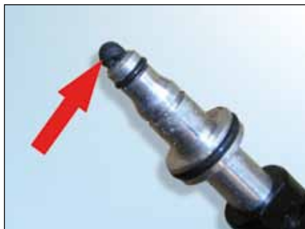
Slika 4: Če starega tesnilnega obročka niste odstranili, ga pritisne v smeri proti CSC, tako da zamaši cevovod.
