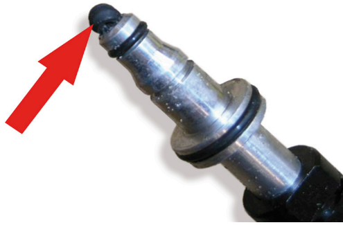
Зображення 4: Якщо не видалити старе ущільнювальне кільце, його затисне у новий гідралічний витискний підшипник і, таким чином, заблокується гідралічна магістраль
