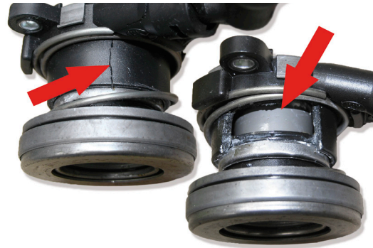
Зображення 5: Гідралічний витискний підшипник пошкоджений в результаті неправильного встановлення
