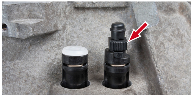
Obrázek 8: Odvzdušňovací nipl lze ovládat rukou popř. stranovým klíčem (13 mm)
