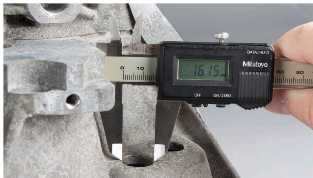
Obrázek 2: Pokud je průměr menší než 21 mm, musí se vyvrtat na min. 21 mm, max. 24 mm
