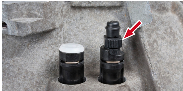
Εικόνα 8: Το ρακόρ εξαέρωσης μπορεί να ενεργοποιηθεί με το χέρι ή με ένα γερμανικό κλειδί (13 χιλ.)
