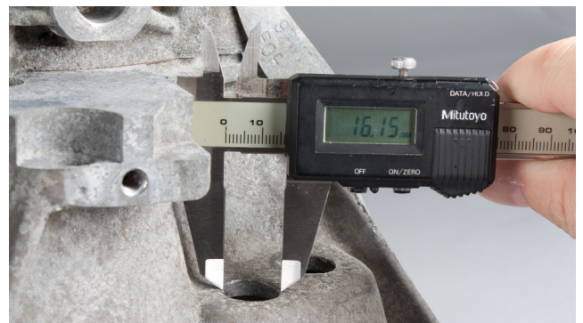
Kuva 2: Jos halkaisija on alle 21 mm, on se porattava vähintään 21 mm ja korkeintaan 24 mm kokoon
