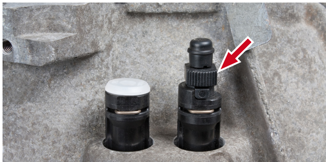
Kuva 8: Ilmausnippaa voi käyttää kädellä tai kiintoavaimella (13 mm)
