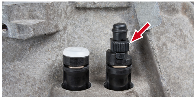
Figur 8: Luftenippelen kan aktiveres for hånd eller med en nøkkel (SW 13)
