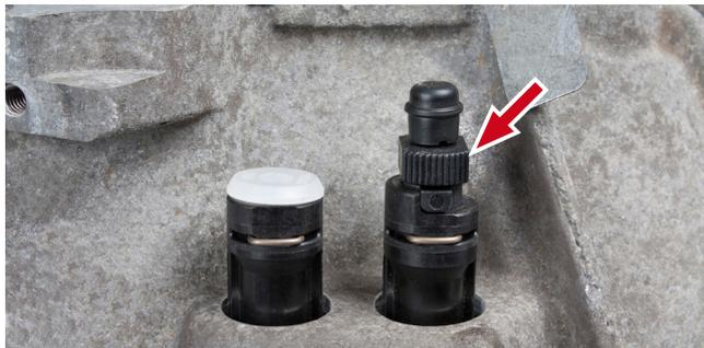
Рисунок 8: Спускной патрубок можно подключить вручную или при помощи гаечного ключа (13 мм)
