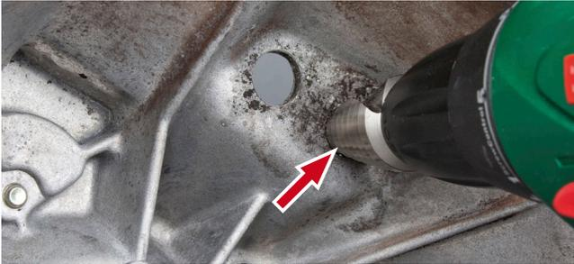
Рисунок 5: Растачивание отверстий
