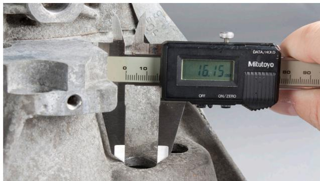
Рисунок 2: Если диаметр отверстий меньше 21мм, то он должен быть увеличен по крайней мере до 21мм, максимум до 24мм
