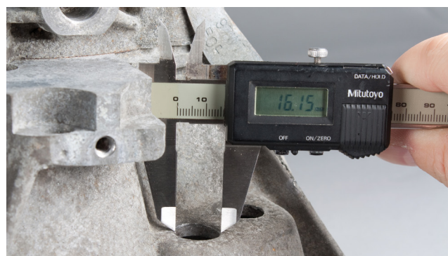
Bild 2: Om diametern är mindre än 21 mm, måste den borraras upp till minst 21 mm, max 24 mm
