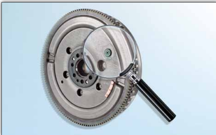
Slika 1: 415 0142 10 – Transportni zatik ostaje unutar sklopa zamašnjaka podjeljene mase (ZPM)
