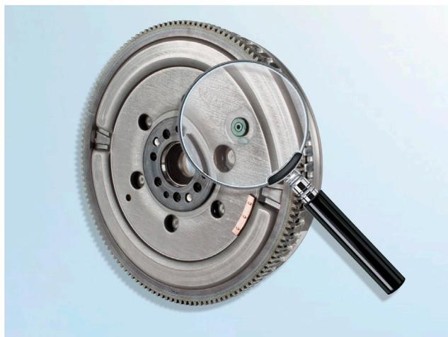
Рисунок 1: Транспортировочный стопор остается в маховике
