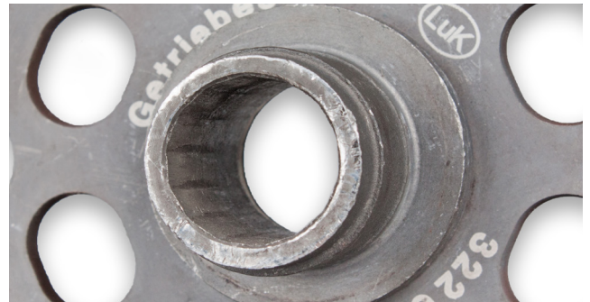
Kuva 2: Navan vahingoittunut profiili
