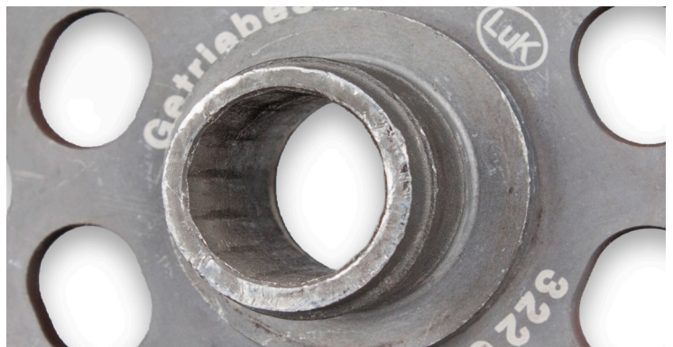
Slika 2: Oštećen nazubljeni profil vratila
