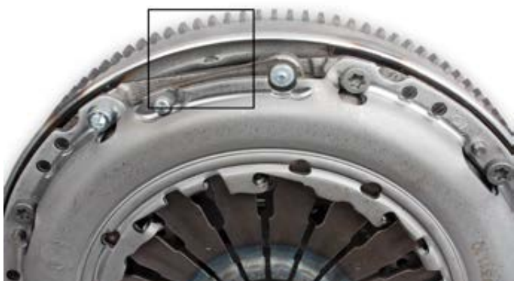
Foto 1: Otarcia powierzchni spowodowane użyciem zbyt długiej śruby
