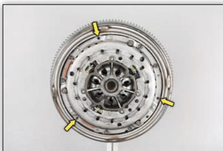
Fig. 9: De resterende 3 bouten met de hand indraaien en met 10,5 \pm 1 Nm vastdraaien
