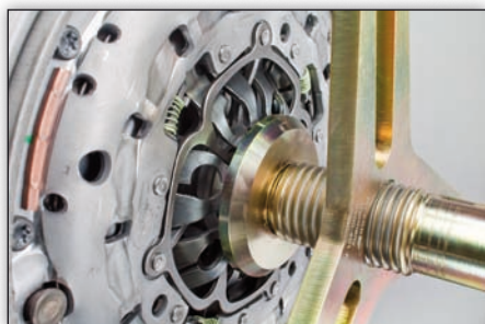
Fig. 8: Diafragmaveer ontspannen door de as van het SAC-gereedschap los te draaien en het gereedschap met behulp van de tapbouten verwijderen
