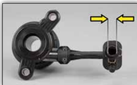
Slika 3: LuK CSC 510 0098 10 hidravlični priključek 11,7 mm
