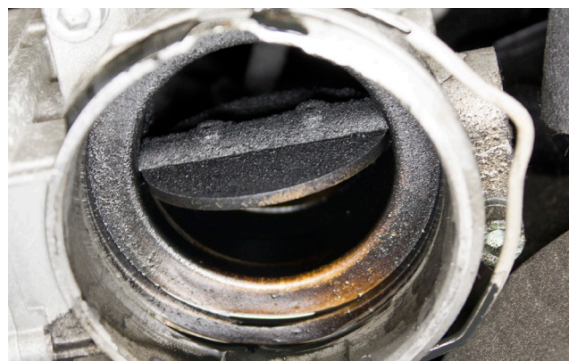
Billede 1: Enhver form for snavs, der findes i gasspjældshuset skal fjernes
