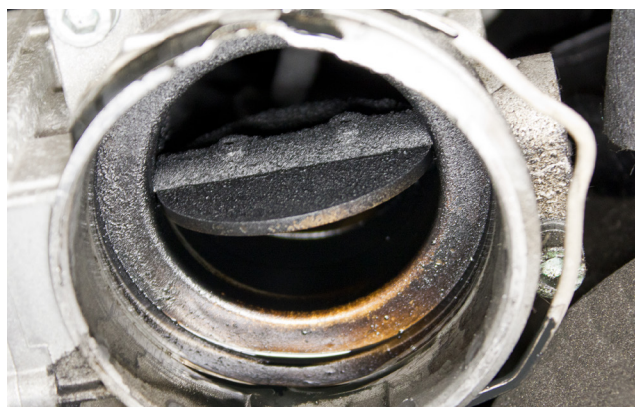
Bild 1: Borttagning av föroreningar i delarna till strypspjället
